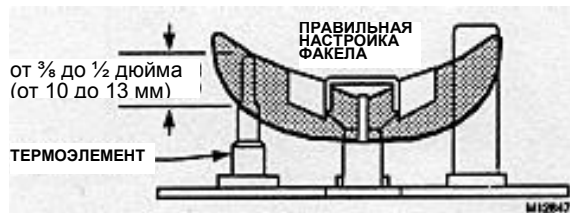
Рис. 2 Наконечник термозлемента должен находиться внутри пилотного факела
